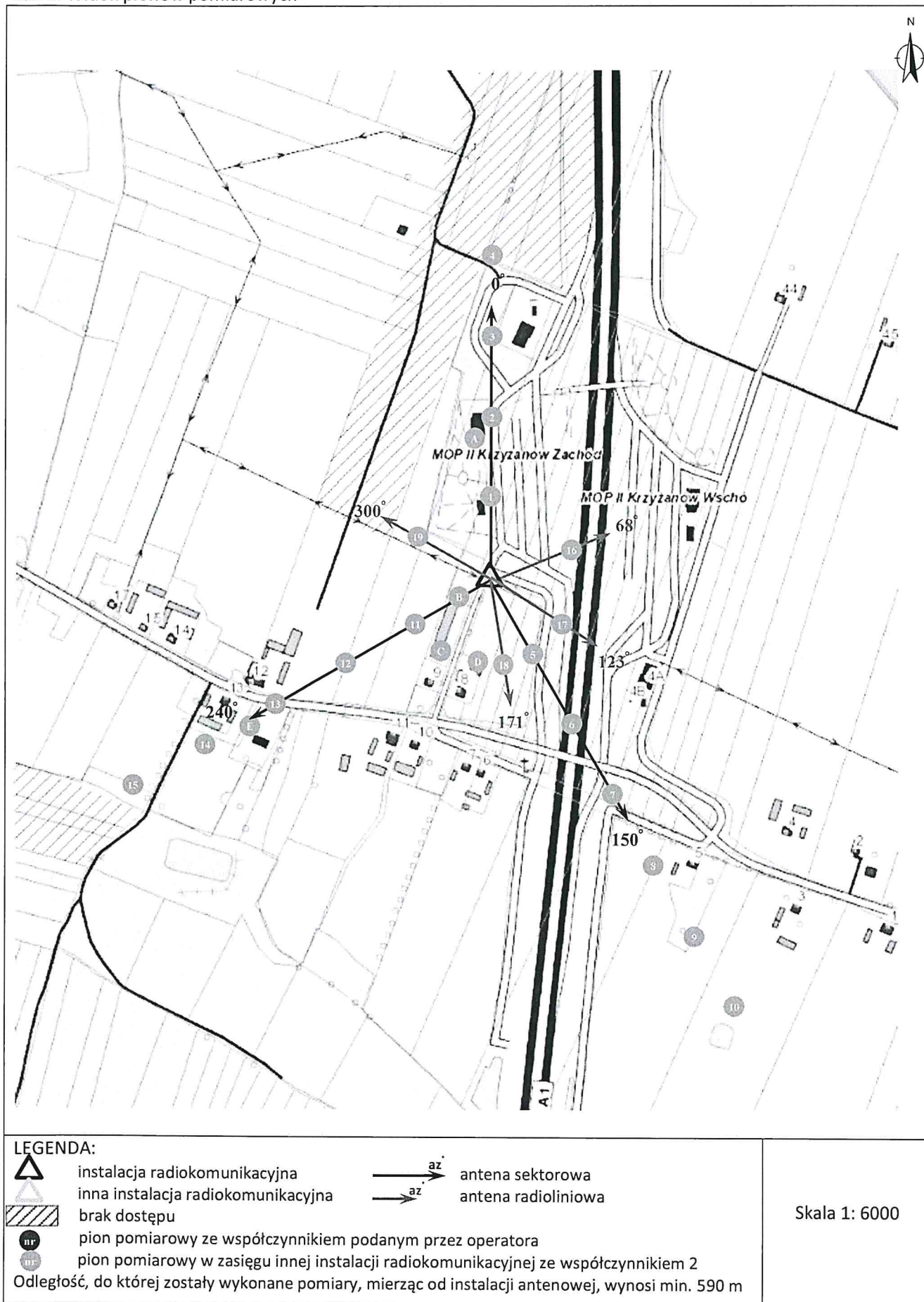
Załącznik 2. Widok pionów pomiarowych
